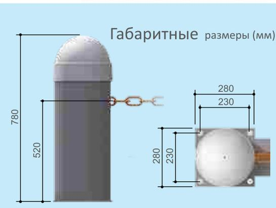
Cat — это запатентованное решение CAME, предназначенное для резервирования одного или нескольких парковочных мест на частных или общественных автостоянках. С их помощью можно контролировать проезды или проходы шириной до 16 м.
