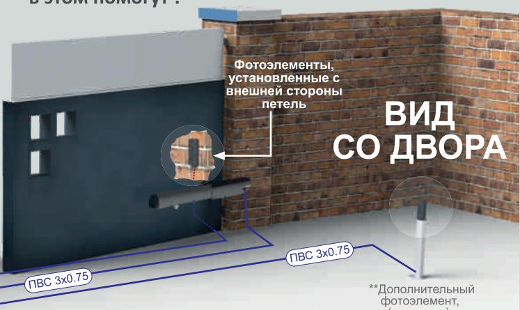
\* В комплекте FAST блок управления находится в корпусе одного из двигателей. Учитывайте это при трассировании кабелей.
